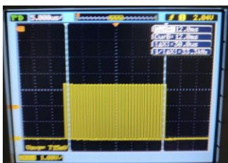
Imagens da tela do osciloscópio com as saídas do GPIO ( General Purpose Input/Output ) recebendo as mensagens do SPII ( Serial Peripheral Interface ).
